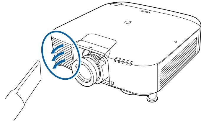
**3** Desserrez les vis et retirez le capot du filtre à air comme illustré (il est fixé avec une attache).
