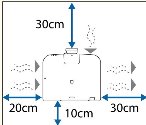
Voir les *Specifications* du projecteur pour connaître les emplacements de la grille d'entrée d'air et de la grille de sortie d'air.
