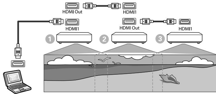
**1** Connectez le projecteur à l'ordinateur avec le câble HDMI, puis connectez le port HDMI1 In et le port HDMI Out des projecteurs avec le câble HDMI.
