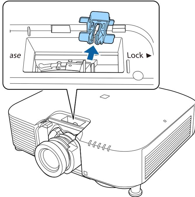
**5** Tenez fermement l'objectif en pinçant le levier de verrouillage et déplacez-le vers la position **Release**.
