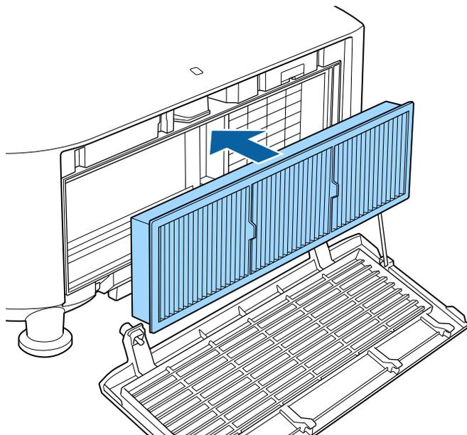
**5** Remplacez le capot du filtre à air comme indiqué et serrez les vis.
